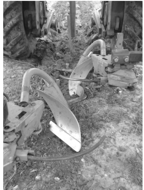
Figure 2 Lames décavaillonneuses interceps équipant un enjambeur
