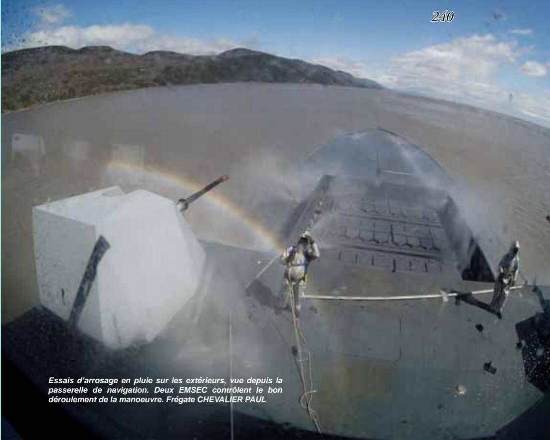
*Essais d'arrosage en pluie sur les extérieurs, vue depuis la passerelle de navigation. Deux EMSEC contrôlent le bon déroulement de la manoeuvre. Frégate CHEVALIER PAUL.*
