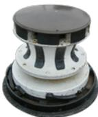
Tréuil à axe vertical servant au relevage des ancrés et à la manoeuvre des aussières.
