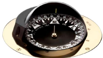
Appareil de navigation servant à suivre une route, donner un cap, la direction d'un objet ou d'un amer visé (gisement, azimut). Le compas magnétique est une boussole. Le compas gyroscopique est un compas électrique.
